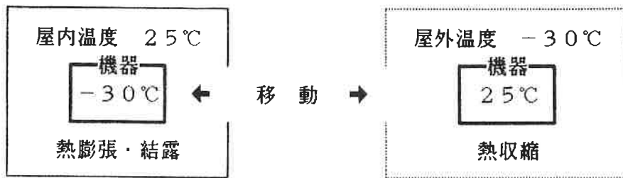
図1-1 屋内・屋外移動で機器が受ける温度変化の例
